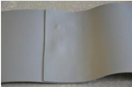
В результате сварки должен получится монолитный шов.
