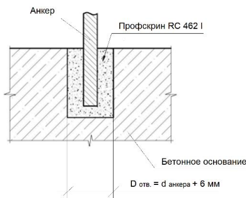
Рис.3 Технология крепления анкера
