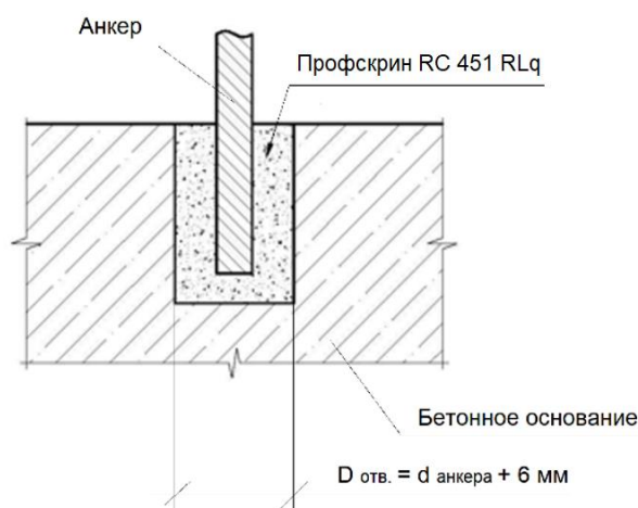
Рис.1 Технология крепления анкера
